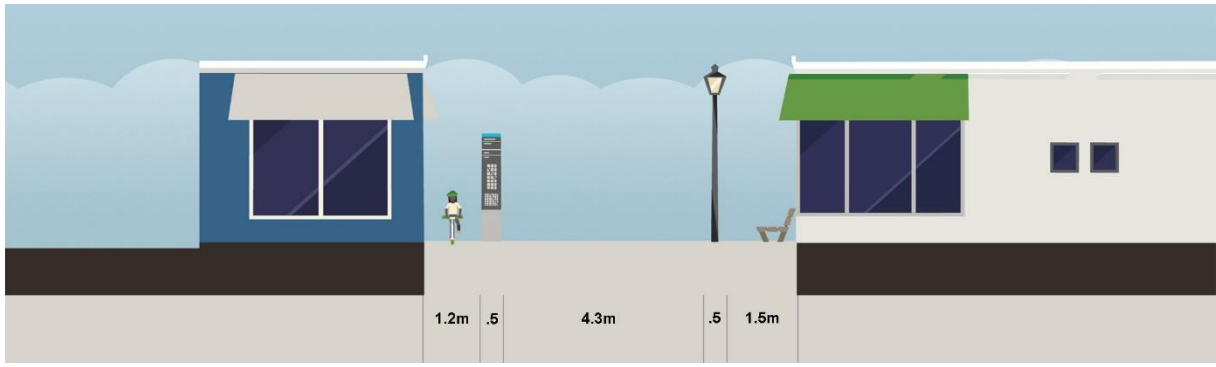
Figura 26 – Seção transversal esquemática para vias compartilhadas residenciais com caixa de 8 metros
