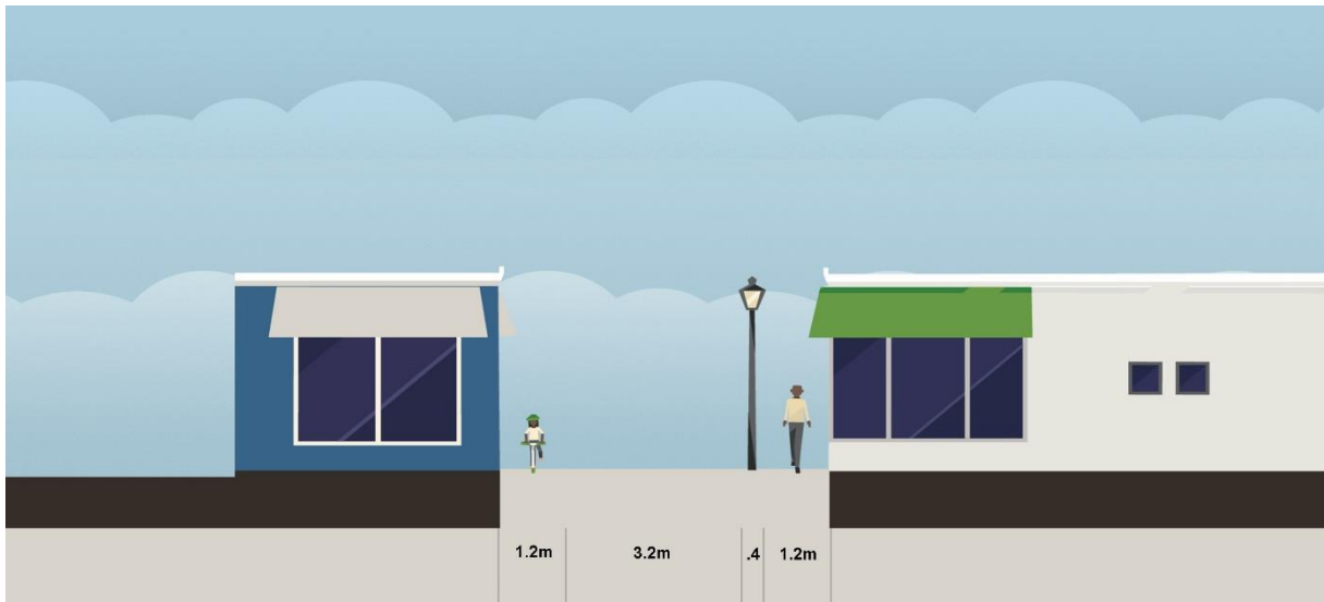
Figura 27 – Seção transversal esquemática para vias compartilhadas residenciais com caixa de 6 metros
